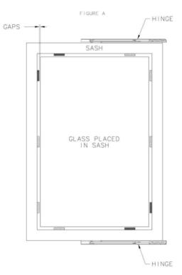
des bords du vitrage, avec un jeu de 0.8 mm (0.030 po) à chaque bloc, l'affaissement du châssis peut atteindre 4.8 mm (0.191 po) pour une fenêtre de  $81.3 \times 121.9 \text{ cm}$  ( $32 \times 48 \text{ po}$ ) et 6.6 mm (0.260 po) pour une fenêtre de  $81.3 \times 81.3 \text{ cm}$  ( $32 \times 32 \text{ po}$ ).
